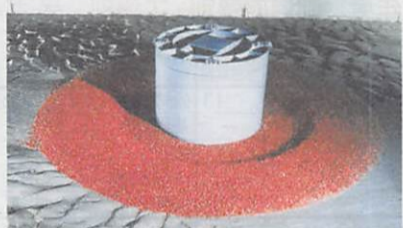
神戸側塔基礎の捨石による洗掘防止工
