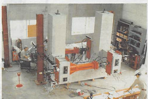
水平梁のねじり実験
